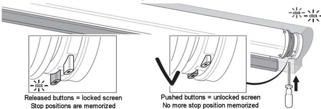
2 -Muovere il telo di proiezione nella posizione di fine corsa basso desiderato, facendo attenzione a non superare il limite indicato nelle tela di proiezione poi rilasciare il pulsante giallo
